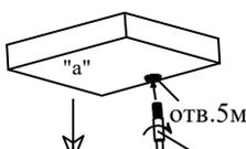
1. Закрутите винт в отверстие диаметром 5 мм в пласти детали "а".
